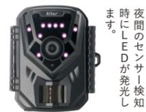
夜間のセンサー検知時にLEDが発光します。
