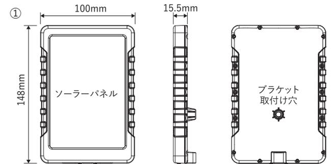
出力端子: 6V (Output DC 6V/2A) ※カメラとの接続用
